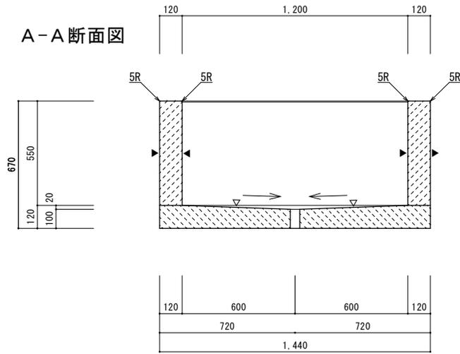
浴槽・平面図、断面
